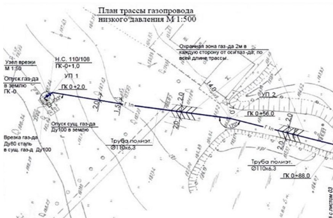
Рисунок 2 Трассировка сети газопровода низкого давления на топоплане
